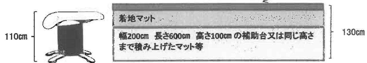
設置案1 : 幅200cm 長さ600cm 高さ100cmの補助台もしくはそれに準じた台を設置し、その上に通常の跳馬用着地マット(200x600x20)を設置しその上にピタリマット(200x600x10)を設置する。
